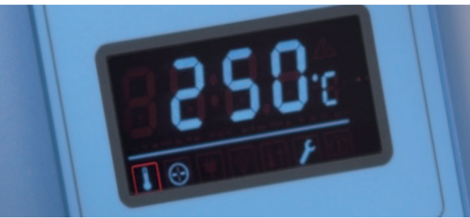
Große, gut ablesbare Vakuumfluoreszenzanzeige mit intuitiver Bedienung
